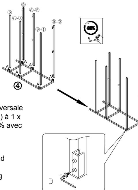
Attachez 2 x barre transversale 1 (5), 2 x barre transversale 4 (8-1 et 8-2) et 2 x barre transversale 3 (9-1 and 9-2) à 1 x cadre latéral 1 (4) à l'aide de 6 x vis (A). Serrez à 80% avec la clé hexagonale (D).
