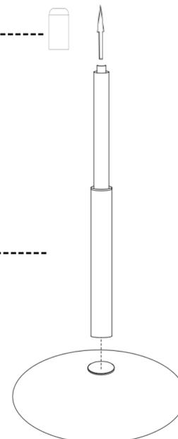
Retirez le capuchon de sécurité en plastique avant l'assemblage.
